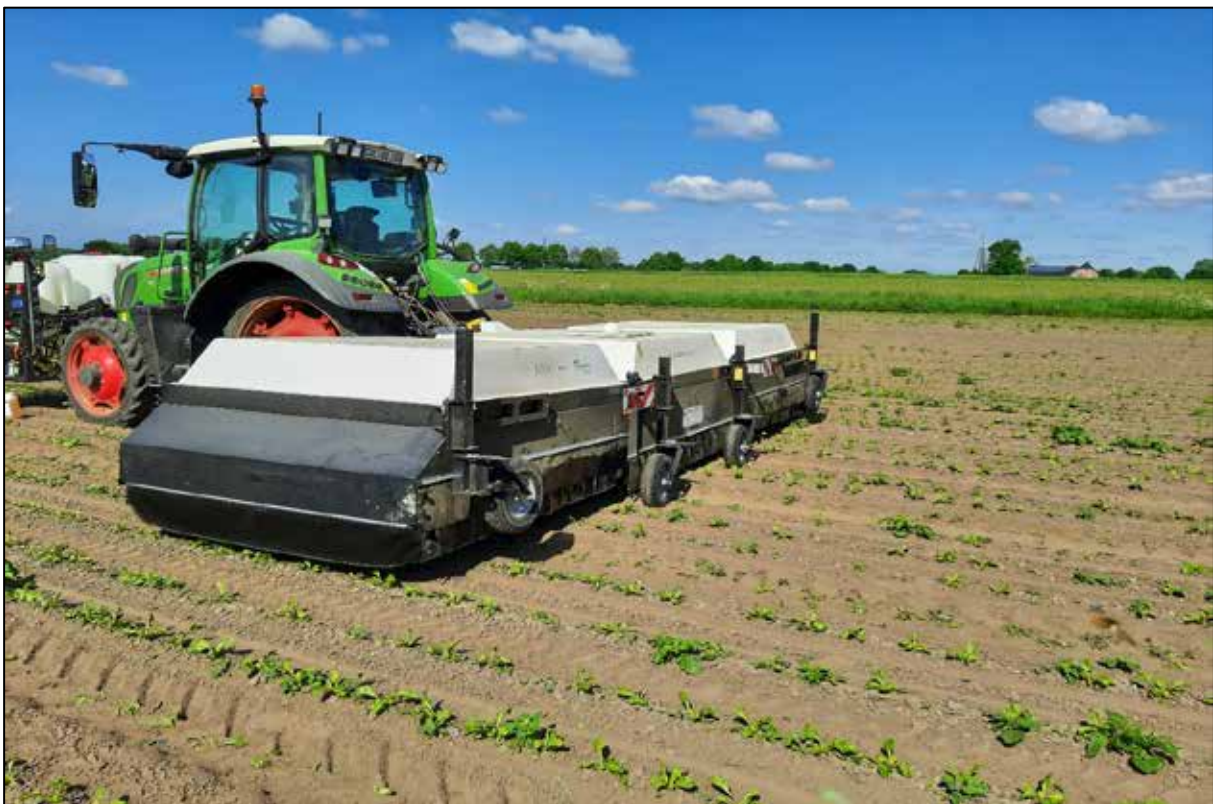
Abb. 2: Spot-Spraying ARA im Zuckerrübenversuchsfeld
